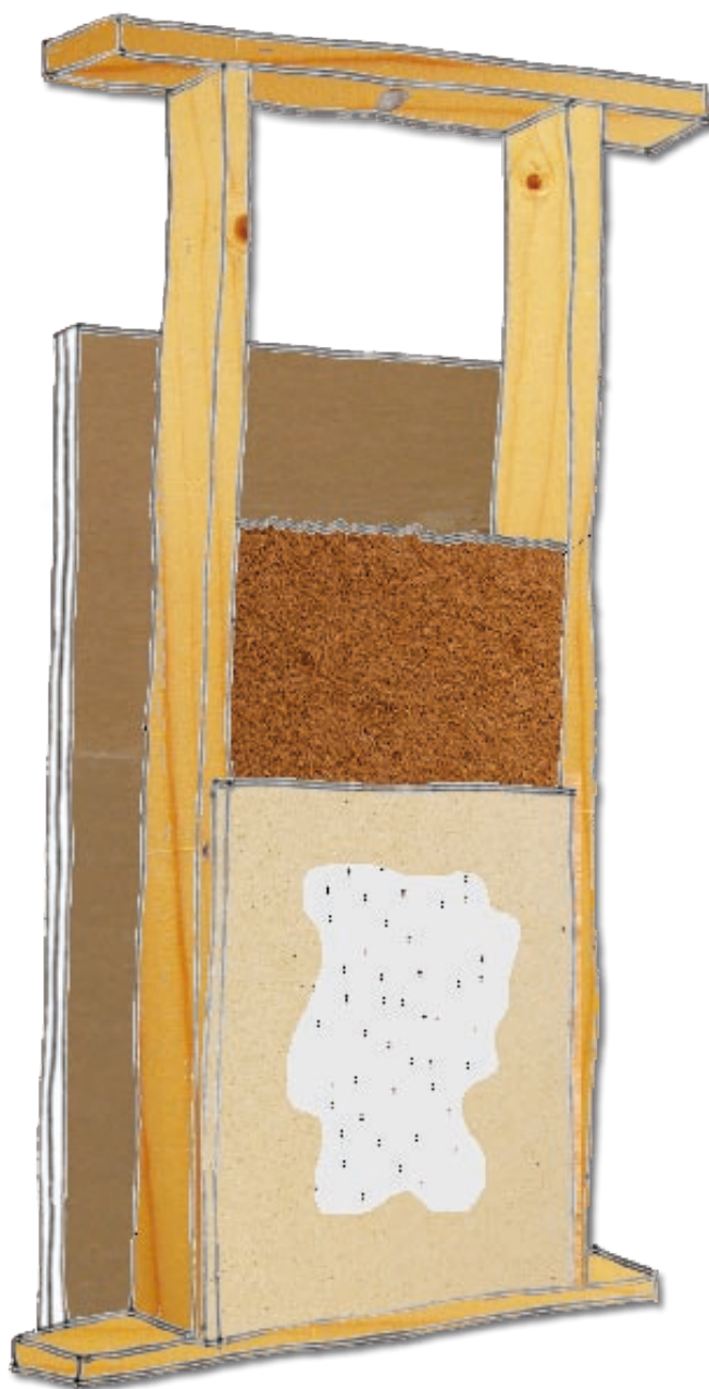
Het principe van de door ORGA ontwikkelde dampopen houtskeletwand. Van buiten naar binnen bekeken: de installatiezone, de constructie- en isolatiezone, en de buitengevelzone.
